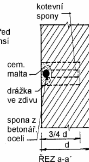
• Schema osazení spon ve zdivu
